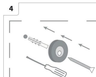
Trapanare i fori e fissare i magneti. Successivamente posizionare il paraschizzi con il lato posteriore rivolto verso l'alto su uno spazio piano (ad esempio sul tavolo) e pulire a fondo la superficie.
