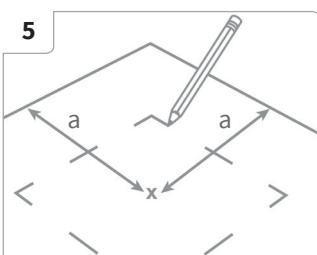
(fr) Marquez la position des plaques autocollantes sur le fond de hotte avec un crayon et avec un triangle à angle droit. Vérifiez la bonne position avant de coller, car les plaques autocollantes sont ultra-adhérentes et difficiles à retirer.
