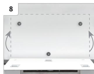
Accrochez le fond de hotte en l'attachant soigneusement aux supports magnétiques de bas en haut et en le déplaçant correctement sur les supports magnétiques avec un peu de poussée latérale.
