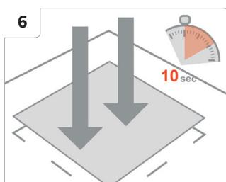
Incollare le piastrelle adesive e premere con forza per 10 secondi con entrambe le mani. Una volta terminato attendere 30 minuti per assicurare la completa adesione.
