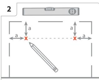
Marquez la position des trous supérieurs pour les supports magnétiques dans la zone marquée à l'étape 1. La distance entre le trou et le bord supérieur et latéral doit être la même. Vous pouvez choisir la distance des bords (a) qui doit être d'au moins 7 cm.
