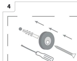
Wywierć otwory i przymocuj uchwyty magnetyczne. Następnie umieść panel na płaskiej powierzchni (np. stół) tylem do góry i dokładnie oczyść powierzchnię.
