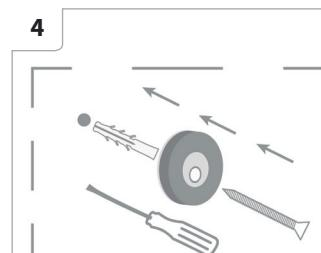
(es) Perfore los agujeros y coloque los imanes. A continuación, coloque la placa de vidrio con el reverso hacia arriba sobre una superficie plana (por ejemplo, una mesa) y limpie bien el cuadro.
