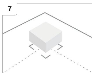
Fixez les pare-chocs muraux en bas à gauche et à droite avec une distance suffisante du bord.
