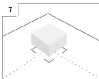
Incollare il paraurti adesivo sulla superficie: uno in basso a sinistra e l'altro a destra mantenendo una distanza sufficiente dai bordi.
