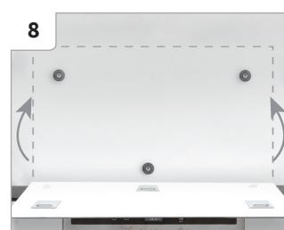
(de) Markieren Sie die Positionen der Klebebleche auf dem Spritzschutz mit einem Bleistift unter Zuhilfenahme eines rechtwinkligen Dreiecks. Prüfen Sie vor dem Verkleben die korrekte Position doppelt, da die Klebebleche ultra-stark haften und nur schwer wieder zu entfernen sind.
