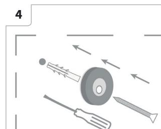
(nl) Boor de gaten en bevestig de magneten. Plaats vervolgens de glasplaat met de achterkant naar boven op een effen vlak (bijv. tafel) en reinig de afbeelding grondig.
