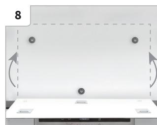
Zawieś panel, delikatnie przechylając go od dołu do góry magnesów i wsuwając go lekkim pchnięciem dokładnie w miejsce magnesów.
