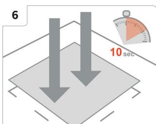
(nl) Plak de plaat en druk deze met beide handen 10 seconden stevig aan. Wacht vervolgens 30 minuten, zodat de volledige kleefwerkzaamheid kan ontdekken.
