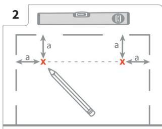
(nl) Markeer de bovenste boorgaten voor de magneten binnen het in stap 1 gemaakte oppervlak. De randafstanden (a) ten opzichte van de boorgaten kunnen zelf gekozen worden en moeten min. 7 cm bedragen.
