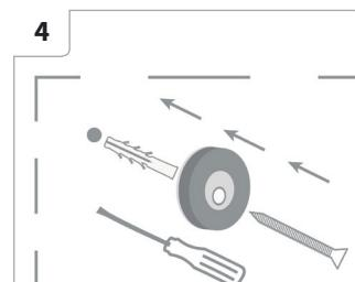
Percez les trous et fixez les supports magnétiques. Placez ensuite la plaque de verre sur une surface plane (par exemple une table) avec le dos tourné vers le haut et nettoyez la surface soigneusement.
