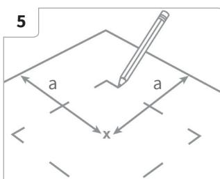
(it) Segnare la posizione delle piastrelle adesive con l'aiuto di un triangolo ad angolo retto. Si prega di controllare che la posizione sia corretta in quanto la colla dell'adesivo è molto resistente e difficile da rimuovere.
