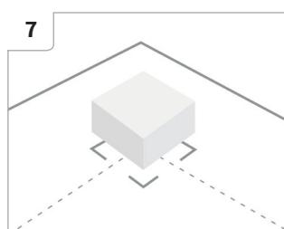
(es) Fije los amortiguadores de pared en la parte inferior izquierda y derecha con una distancia suficiente desde el borde.
