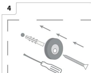
Vyralte otvory a připevněte magnety. Poté položte skleněnou desku rubovou stranou nahoru na rovný povrch (např. stůl) a obrázek důkladně očistěte.
